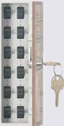
Simulatore con 12 possibilità di guasto tramite interruttori
