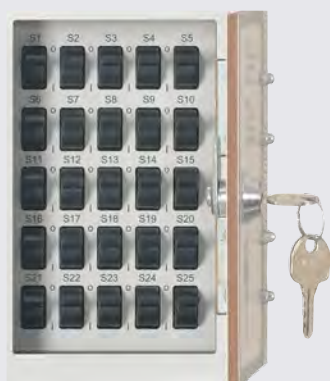
Simulatore con 25 possibilità di guasto tramite interruttori
